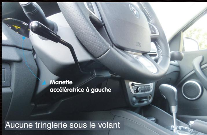
Cet équipement, installé sur des véhicules en boîte automatique, peut être **combiné à un levier de frein manuel**.
